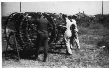
Im Sommer bleiben die Trommeln zum Trocknen der von den Besatzungen nach Hause gebrachten Filme im Freien aufgestellt. Personal der Bildstelle der 3.(F)/22 haspelt im Juli 1942 in Dno einen Reihenbildfilm auf das Drehgestell.
