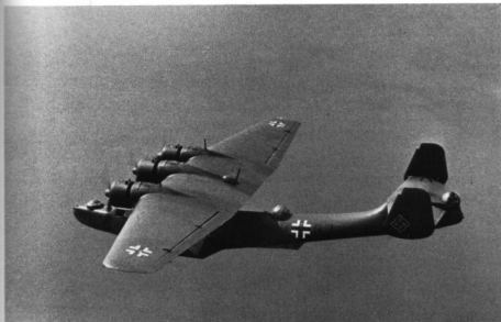
Als schnelles, seetüchtiges und geräumiges Seenotflugzeug bewährte sich die Do 24T, die bei Dornier für einen Lizenzbau in den Niederlanden entwickelt worden war. Mit drei Drehtürmen erwies sich das Flugboot für angreifende Jäger als ein schwer verdautlicher Brocken.
