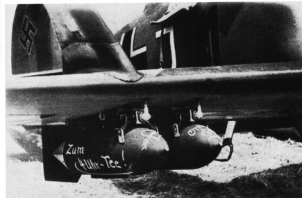
Zwei 50-kg-Bomben unter der rechten Fläche einer Hs 123. Die II.(S)/LG 2, die bereits in Polen ihre Feuer-taufe bestanden hatte, blieb auch während des West-feldzuges die einzige reine Schlachtfliegergruppe der Luftwaffe.
