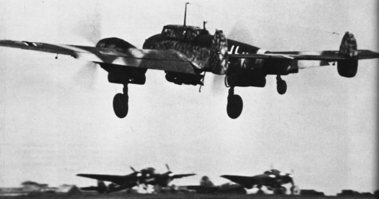
Oben: Der Zerstörer Bf 110 in seiner Version Bf 110F-1 als Bombenträger. Mit zwei Splitterbomben SD 250 am Rumpf-ETC hebt eine Maschine der IL/ZG 1 im Juni 1942 von der Startbahn in Charkow ab.
