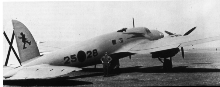
Erst mit Lieferung der He 111 konnten die Kampfstaffeln der Legion Condor mit denen der Gegenseite gleichziehen. Mit 1000 kg Bombenlast und 375 km/h Höchstgeschwindigkeit lagen die Leistungen der He 111 über denen der »Katiuska«.
