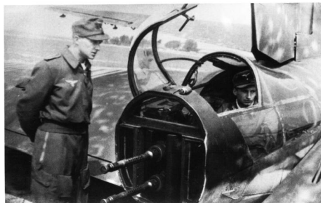
Sonderausführung des Heckstandes der He 177. Normalerweise mit einem MG 151/20 bestückt, besteht der Waffensatz dieser He 177A-5 aus zwei gekoppelten MG 131.
