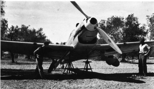
Fahrwerk-Funktionsprüfung an einer Bf 109D in La Cenia. Gegen Ende der Feindseligkeiten gelangten auch noch einige Bf 109E nach Spanien. Mit einer v_{max} von 550 km/h übertraf die Bf 109E die D-Version um rund 100 km/h.
