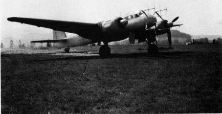
Bei der II./NJG 2 sind die lange herbeigesehnten Ju 88 der G-Reihe eingetroffen. Schneller und mit größerer Flugdauer, erlaubt das Flugzeug den Besatzungen, länger im Pulk der Bomber »mitzuschwimmen« und mehr Erfassungen zu bekämpfen. Ju 88G-1, Kassel-Rothwesten.
