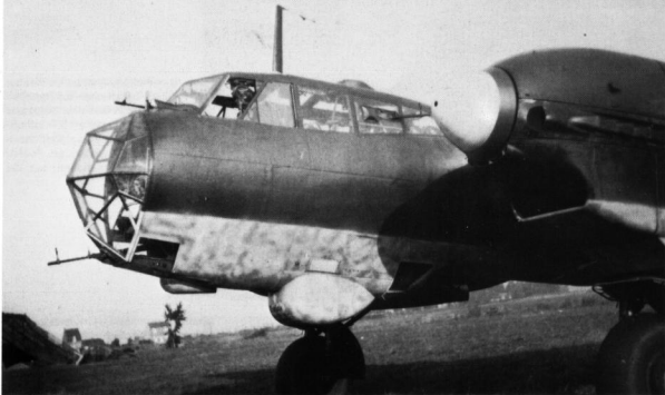
Oben: Mit Do 215B-4 unternahm die 4.(F)/Aufkl.Gr.Ob.d.L. von Merville aus verstärkt Aufklärungsflüge nach England. Für das bevorstehende Unternehmen Adler galt es, die Zielkartei zu vervollständigen. In einer Rumpf- beule das Reihenbildgerät 30x30.
