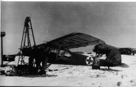
Das Sanitätsflugzeug Fi 156D konnte eine Bahre und eine Begleitperson im schmalen Rumpf aufnehmen. Die D-ELXV der Sanitätsflugbereitschaft 17, Ende Februar 1942; beim Triebwerkswechsel in Nikolajew.
