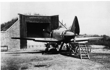
Justieren der Waffen eines Jägers Reggiane Re 2002 auf dem Schießstand. Kaum eines der italienischen Jagdflugzeuge gelangte zu einem Frontverband der Luftwaffe, sie wurden überwiegend den Jagdfliegerschulen zugeteilt.
