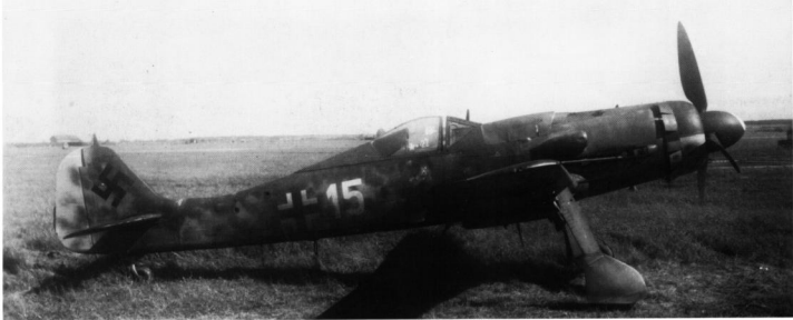
Mit der »Langnasen-Dora«, der Fw 190D-9, angetrieben von einem Reihenmotor Jumo 213, erhielten einige Jagdgruppen im Sommer 1944 einen der amerikanischen »Mustang« gleichwertigen Höhenjäger.
