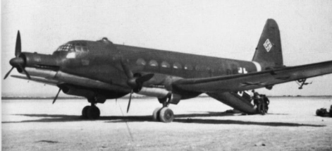
Im Truppenversuch beförderten Ju 252-Vorserienmuster sperrige Güter auf den Kriegsschauplätzen im Osten und Südosten. Über eine Heckklappe ist eine rasche und hindernisfreie Beladung des Flugzeuges möglich.
