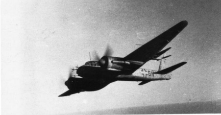
Eine Ju 88C-6 der 5./NJG 2 über Holland. Die Maschine ist mit dem NJ-Suchgerät FuG 212 «Lichtenstein» ausgerüstet. Über den Auspuffstutzen der Triebwerke sogenannte Flammvernichtungs-(Flav)Rohre, mit denen die verräterischen Auspuffflammen verdeckt abgeleitet wurden.
